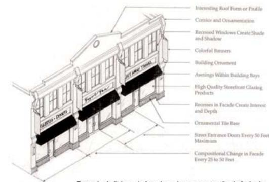
Exemplo de linha guia form-based para construção de fachadas. Gráfico cortesia de Freedman Tung & Bottomley Urban Design
